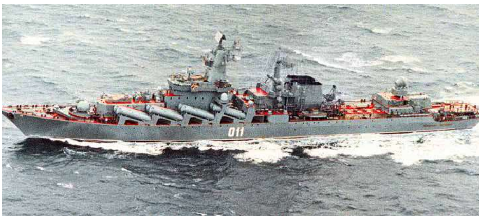
Czerwona Ukraina , dzisiejszy Wariag , krótko po przejściu na Pacyfik. Trzeci z Atlantów już w czasie budowy otrzymał nowoczesniejszy radar MR-750 Frigate-MA i inne urządzenia, ale też nowe pięcioskrzydłowe śruby napędowe.
