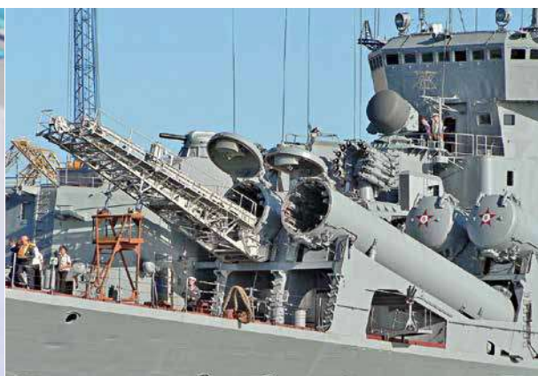
Wyrzutnia SM-248 na Moskwie z podłączonym urządzeniem załadowczym pocisków Bazalt .
