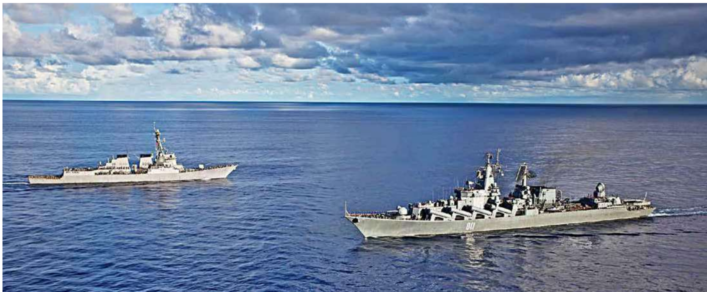
Wariag w towarzystwie niszczyciela USS McCampbell (DDG 85) typu Arleigh Burke Flight IIA w trakcie ćwiczenia „Pacific Eagle” w 2011 r. Porównanie tych okrętów pokazuje, jak archaicznymi systemami elektronicznymi dysponuje jednostka rosyjska – przestarzałe anteny radarów, z ogromną Woschoda na czele, świadczą o ich pochodzeniu z minionej epoki.
