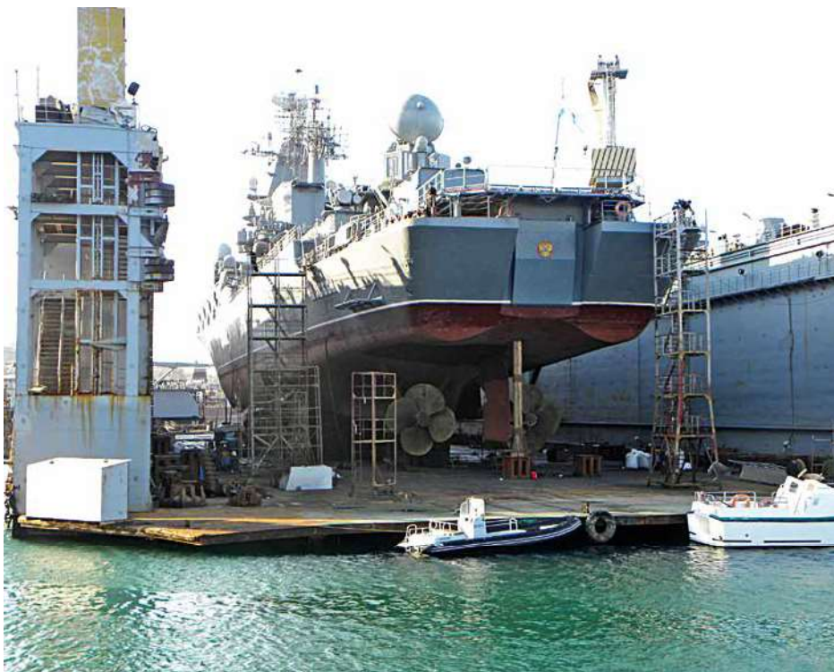
Moskwa na doku pływającym. Widać pierwotne czterokrzydłowe śruby napędowe i pokrywę pomieszczenia sonaru holowanego Piatina .
