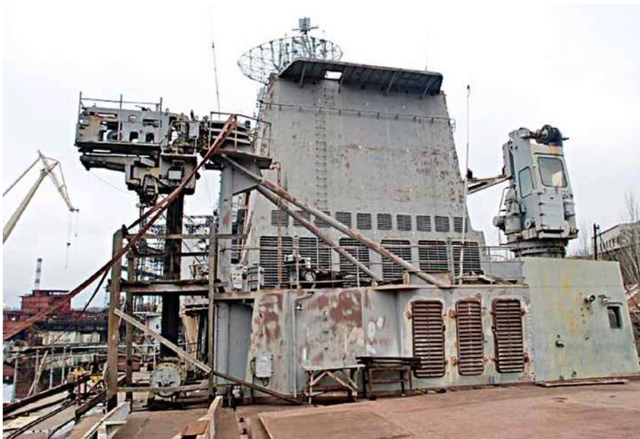
Admirał Flota Łobow otrzymał nowy, jednobryłowy komin i lżejszy żuraw ładunkowy zainstalowany w nowym miejscu.
