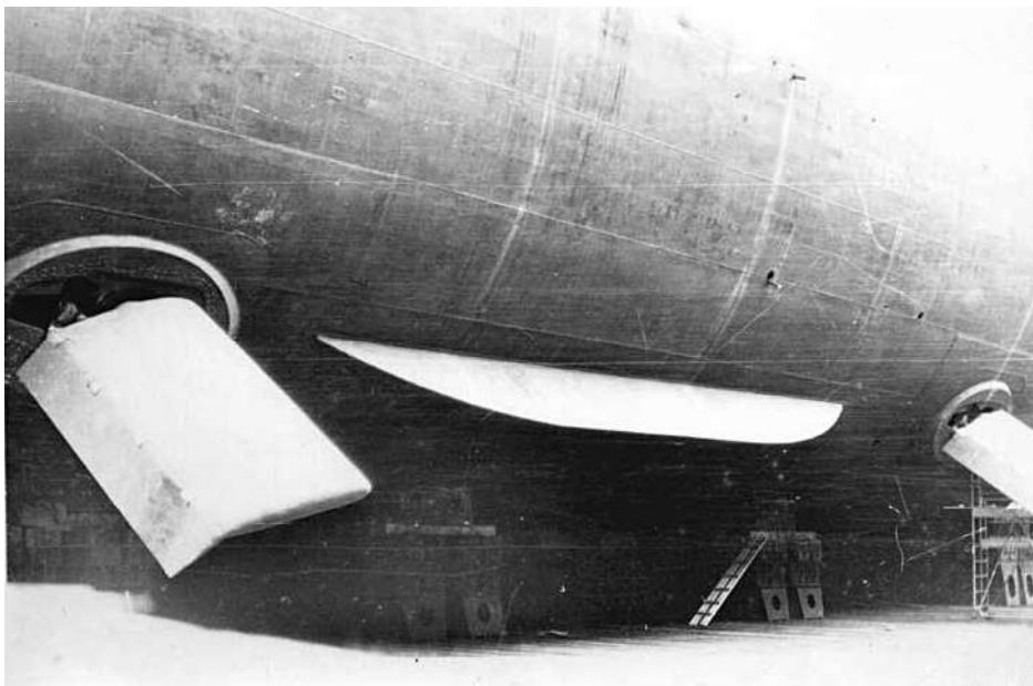
Na próbach morskich krążowników okazało się, że mają dobrą manewrowość i stateczność. Tę drugą gwarantowały po dwie pary stępek obłowych i aktywnych stabilizatorów płetwowych UK 134-6.
