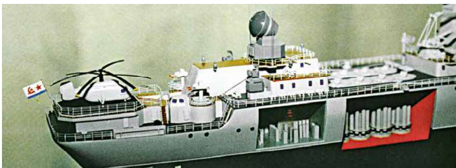
Model pokazujący rozmieszczenie elementów raketowego systemu przeciwlotniczego Fort na krążownikach proj. 1164.
