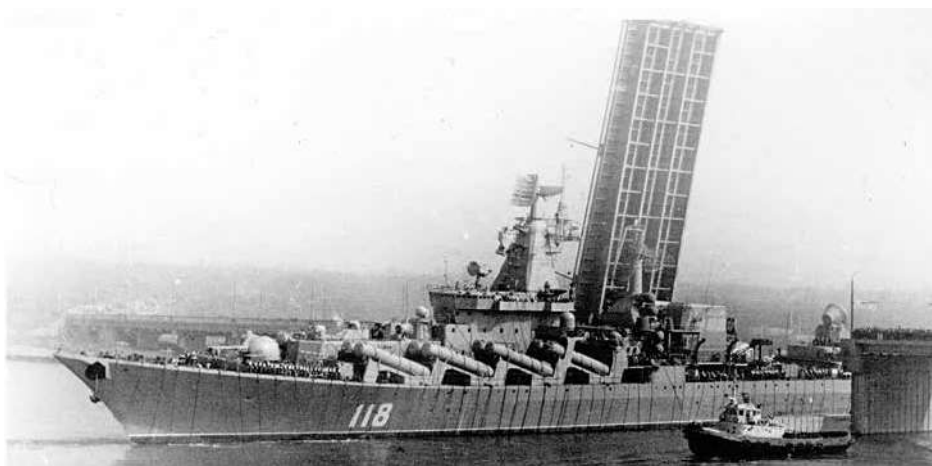
Drugi w serii Marszał Ustinow przekracza most zwodzony przez Inguł w Nikolajewie w drodze na próby. Kadłub opleciony kablami demagnetyzacyjnymi.
