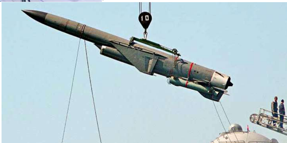
Model pocisku 3M70 systemu P-1000 Wulkan (u góry po lewej) i pocisk 4K80 systemu P-500 Bazalt w czasie ładowania do wyrzutni Moskwy. Różnice w konstrukcji przyspieszacza startowego są widoczne gołym okiem. Prawdopodobnie – wbrew wywodom na rosyjskich stronach internetowych – Atlanty wciąż wykorzystują przestarzały, wprowadzony do uzbrojenia w połowie lat 70., system Bazalt .
