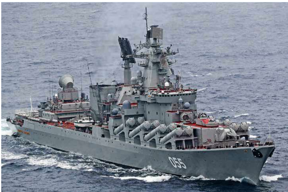
Pomiędzy 2011 a 2016 r. Marszał Ustinow przeszedł w stoczni SRZ-35 Zwiedzoczka w Siewierodwińsku remont połączony z ograniczoną modernizacją. Naprawiono m.in. turbiny gazowe, wymieniono turbogeneratory, a także zainstalowano nowe urządzenia elektroniczne, w tym radary Podbierzowik-ET2 i Frigat-M2M , nowy sonar oraz systemy walki elektronicznej. Bez zmian pozostało uzbrojenie główne jednostki. Inwestycje w trzy nieperspektywiczne krążowniki świadczą o „krótkiej kołdrze” Kremla i niemożności budowy okrętów podobnej wielkości nowej generacji.
