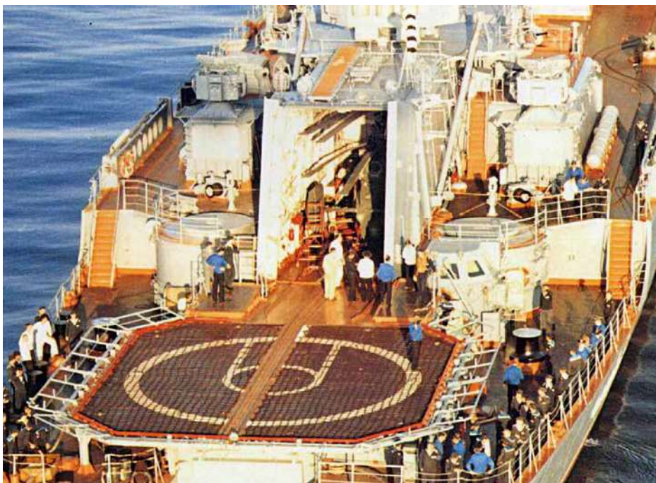
Wtaczanie śmigłowca Ka-25C do hangaru. Jego podłoga jest poniżej lądowiska, co jest typowe dla wielu okrętów sowieckich z lat 70. i 80. Widać szynę ułatwiającą operację. Maszynę wciąga urządzenie z kabestanami i ciężnami.
