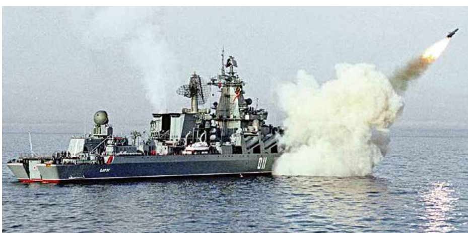
Wariag (eks- Czerwona Ukraina ) odpala pocisk przeciwokrętowy 4K80 systemu P-500 Bazalt , zasadniczego oręża „zabójców lotniskowców”. Według niektórych opracowań Wariaga uzbrojono w nowszy system P-1000 Wulkan .
