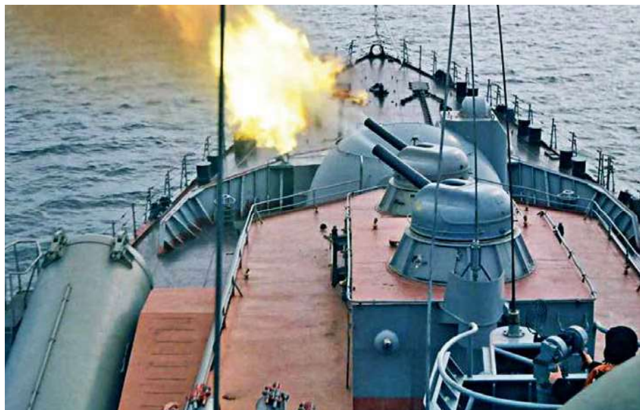
Krążowniki projektu 1164 mają po sześć zestawów artyleryjskich AK-630M. Na zdjęciu dziobowa bateria w akcji.
