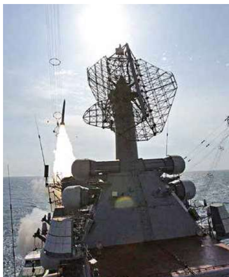
Odpalenie pocisku systemu Fort z Wariaga. Na pierwszym planie widoczna jest antena radaru dalekiego zasięgu Woschod do obserwacji przestrzeni powietrznej, a także anteny systemów walki elektronicznej Koico i Gurzul-A/B .
