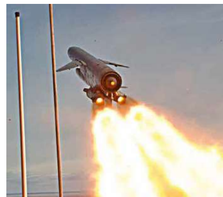
Pocisk 4K80 systemu P-500 Bazalt chwilę po opuszczeniu wyrzutni SM-248. Rozpędzają go dwa przyspieszacze startowe na stały materiał pędny. Po ich odrzuceniu rakietka zmierza do celu napędzana silnikami turboodrzutowym KR-17-300.
