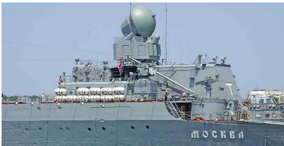
Rufa Moskwy . Widać hangar śmigłowca, podniesioną do pozycji startowej wyrzutnię ZIF-122 systemu Osa-MA , dużą antenę stacji radiolokacyjnej 3R41 Woina kierowania ogniem systemu przeciwlotniczego S-300F Fort , pod nią system kierowania ogniem 4R33A Osy , a na burcie pokrywę wyrzutni torped.
