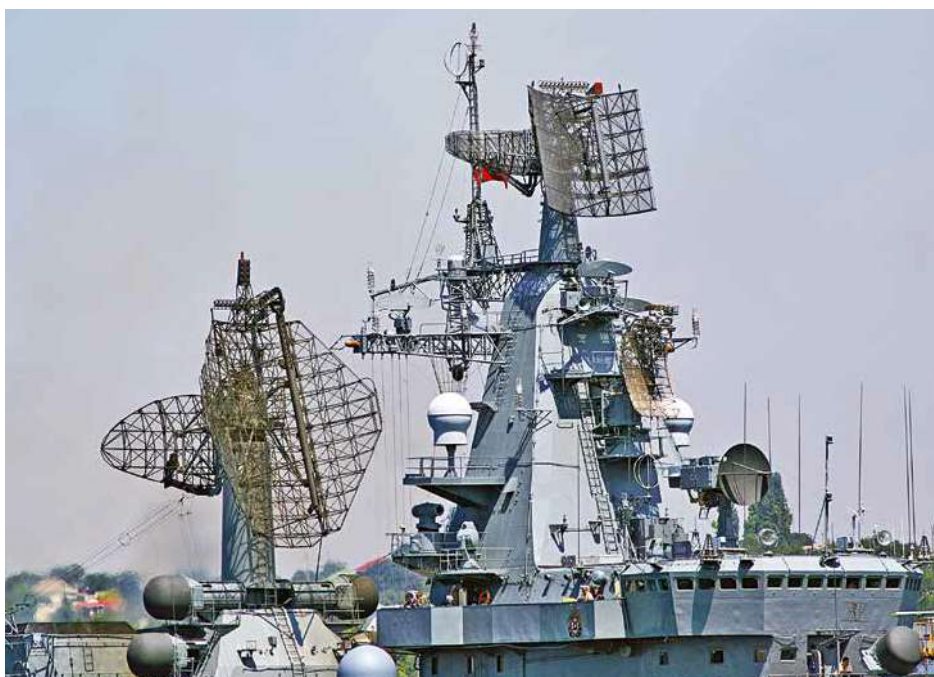
Na dwóch masztach wieżowych zgromadzono większość anten i czujników urządzeń elektronicznych. Duża antena po lewej należy do stacji radiolokacyjnej MR-600 Woschod , na topie masztu przedniego jest z kolei antena radaru MR-700 Friegat-M , zaś pod nim antena Argon-K-1164 systemu kierowania ogniem systemu Bazalt . Na dachu nadbudówki system kierowania ogniem artylerii Lew-218 .
