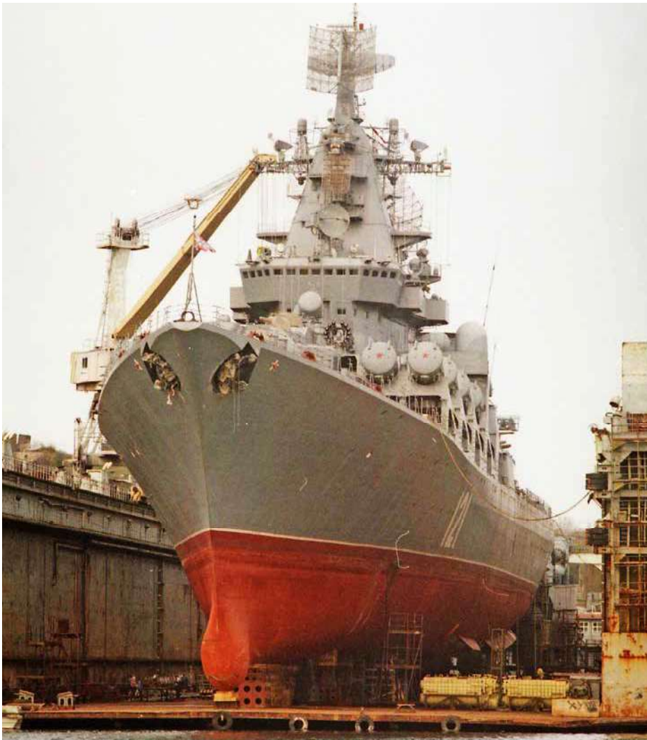
Moskwa na doku pływającym, Sewastopol, 2004 r. Wychylona stewa dziobowa jest u dołu zakończona gruszką, mieszczącą antenę stacji hydroakustycznej Platina.
